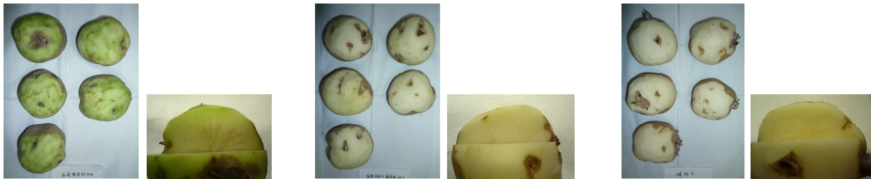
写真2 積算照射時間約 450 時間後(1日 10 時間の点灯で 45 日分に相当)の緑化状態を比較した例 馬鈴薯表面付近の照度は白色蛍光灯 193 lx、本照明装置:266 lx
