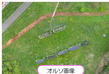
赤外線カメラを用いたドローン空撮画像からの 太陽光パネルのホットスポット診断
