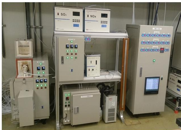
火力発電所環境設備の安定運転・コスト低減に資する脱硫・脱硝触媒の性能試験装置
