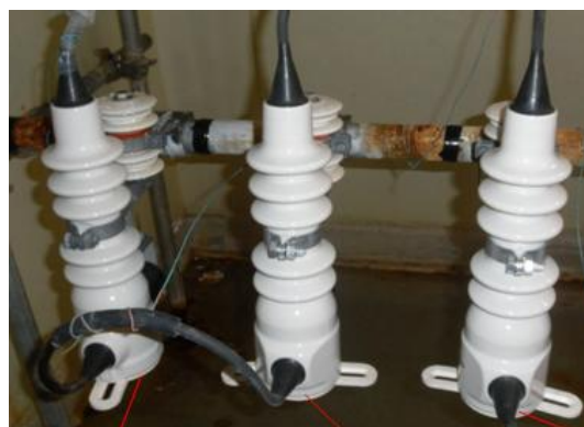
CF遮断器磁器部本体と組合せた試験状況
